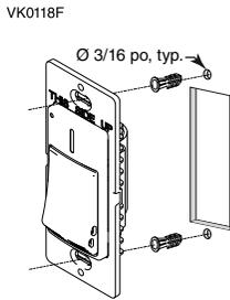
4 Retirer la commande, percer les deux trous (3/16 po Ø) des vis dans le mur et y insérer les douilles à expansion (incluses).
