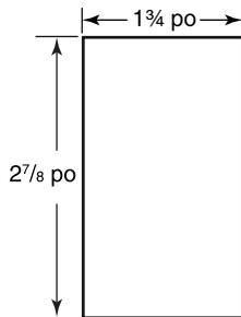
3 Placer la commande temporairement au-dessus du trou et marquer la position des deux trous pour les vis de montage.
