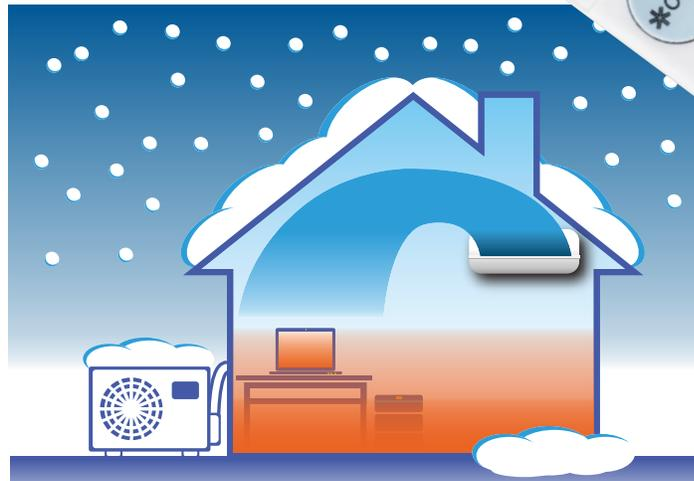
Cette fonction permet un fonctionnement de refroidissement même lorsque la température extérieure est de 14 °F (-10 °C). Cette fonction peut être utilisée pour refroidir en continu par exemple une salle pour l'eau chaude ou une salle avec des serveurs informatiques lorsque la température extérieure est basse.
